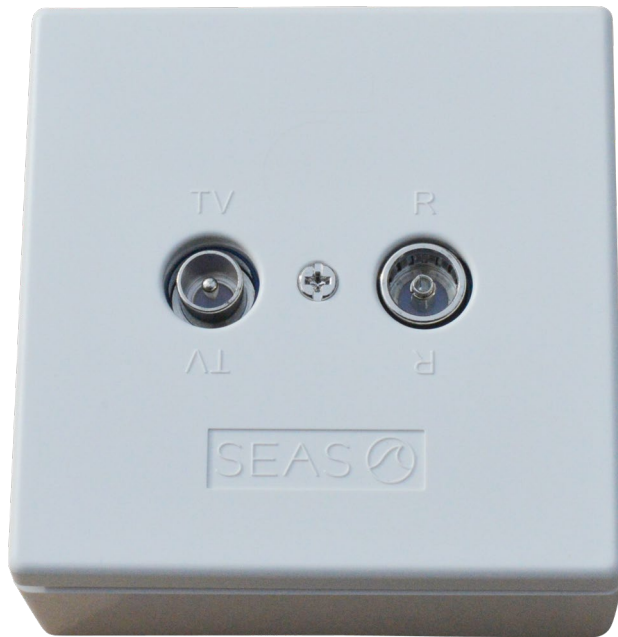
OUTLET TV/R - w. IEC connectors and Frame Size: (H) 86 x (W) 86 x (D) 32 mm, RAL 9010
