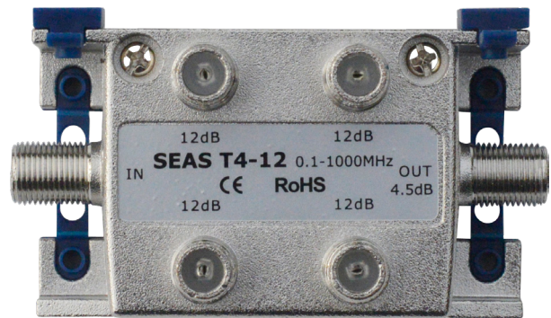
4 Way tap off - w. F connectors Size: (H) 46 x (W) 76 x (D) 32 mm
